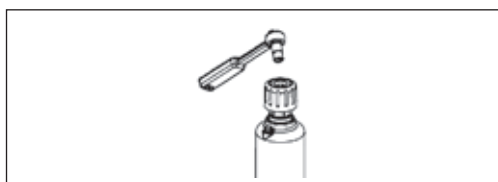
Рис. 11. Настройка перепада давления производится стандартными ключами
